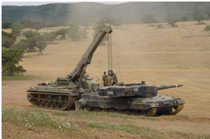
Los actuales carros de recuperación sobre chasis "M-47" tendrán que ser sustituidos en breve
