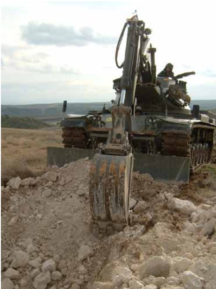
El carro de zapadores "Alacrán" sobre chasis "M60 A1" tendrá que ser sustituido en los próximos años.
