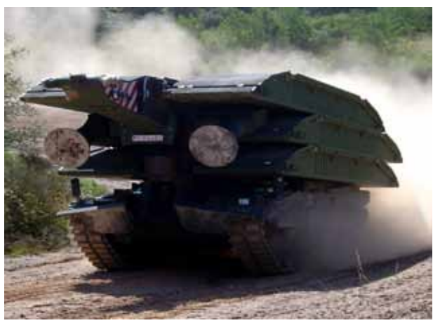
El futuro lanzapuentes también podría realizarse con el sistema modular "PSB2", dotado de tres tramos de puente
